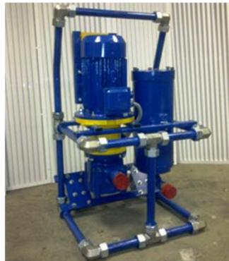
Портативные фильтрационные установки предназначены для очистки гидроликоидностей после транспортировки и хранения при заправке/дозаправке гидросистем машин, а также для периодической очистки рабочей жидкости с целью обеспечения бесперебойной работы машин и оборудования
