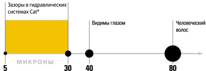
Стандартная величина зазоров между металлическими деталями в гидравлических системах Caterpillar® составляет 5–30 микрон (один микрон составляет одну миллионную часть метра). Поэтому даже невидимые частицы могут привести к серьезным повреждениям.
